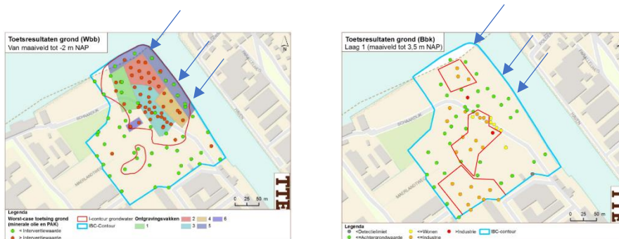
Figuur 2.2-1 Toetsresultaten grond (links: 0-2 m- mv; rechts: 2-7 m- mv)
