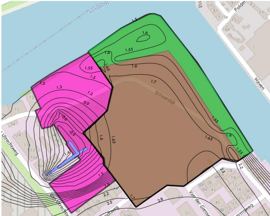
Figuur 10 - grondwaterstand nieuwe situatie [m+NAP] met bebouwing/verharding
