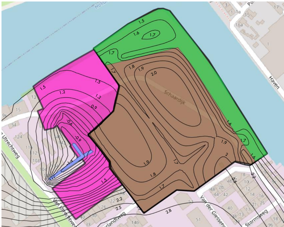
Figuur 11 - grondwaterstand na aanleg drainage echter in plaats van verharding gras op het maaiveld in nieuwe situatie [m+NAP]
